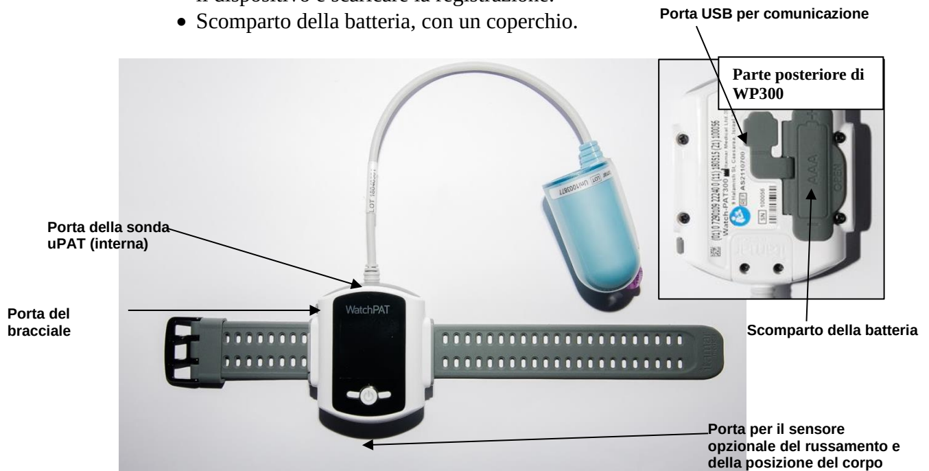
Figura 4 – Porte di manutenzione e periferiche
